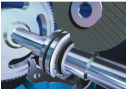
3 Altes Lager demontieren (ungeteilte Lager mit Spannhülse vorsichtig mit Trennschleifer zerschneiden)
