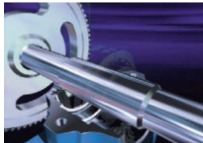
4 Außenringhälfte in Gehäuseunterteil einlegen und auf Welle montierten Innenring ausrichten, dann Innenringhälften verschrauben
