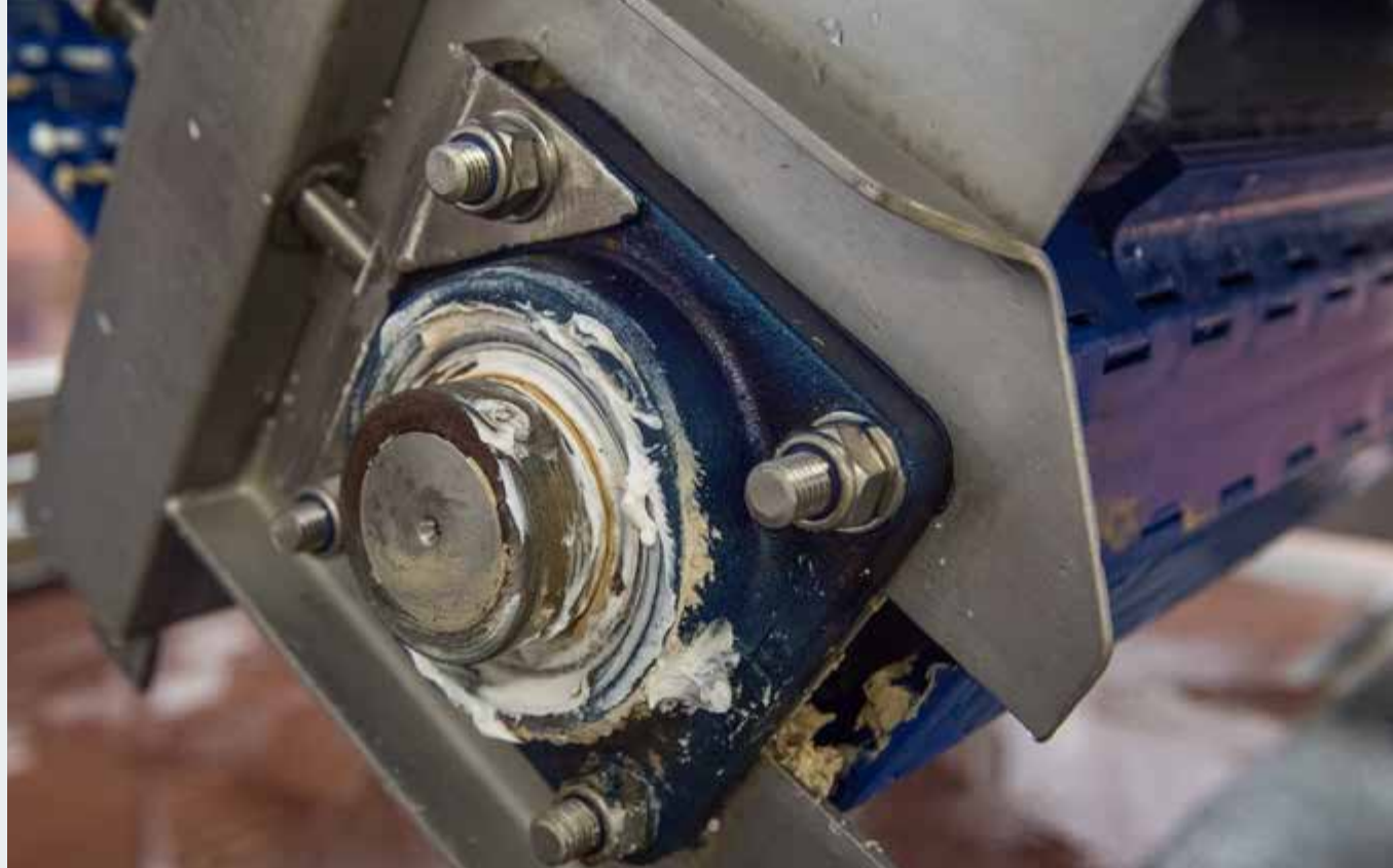
Overtollig vet van het lager heeft zich verzameld op de hygiënische transportband, waardoor de kans groter is dat bacteriën of allergenen in de voedselzone terechtkomen en de voedselveiligheid in gevaar brengen.
