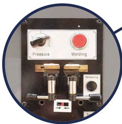
Knip-, las- en slijpinrichting t.b.v. lintzaagblad
